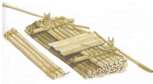
Figure 42 - Construction d'un radeau de bois. Le chevalet supportant une grande rame (l'empeinte) est appelé "picon". Il est fixé à chaque coin du radeau. Le Haut Rhône – André Julliard
