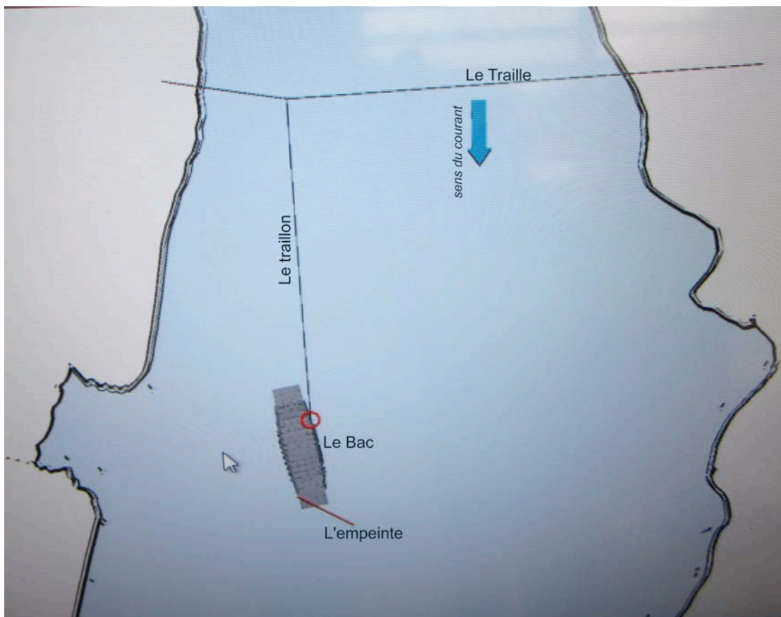
Figure 32 - Fonctionnement d'un bac à traile. L'embarcation est reliée à un traile, c'est-à-dire une corde de chanvre qui peut atteindre 200m et peser jusqu'à 1 tonne, tendue entre deux mâts plantés de chaque côté du lit principal du fleuve. L'empeinte, ou gouvernail, fixée sur le bac permet de contrer le courant, et ainsi faire dériver l'embarcation jusqu'à l'autre rive
