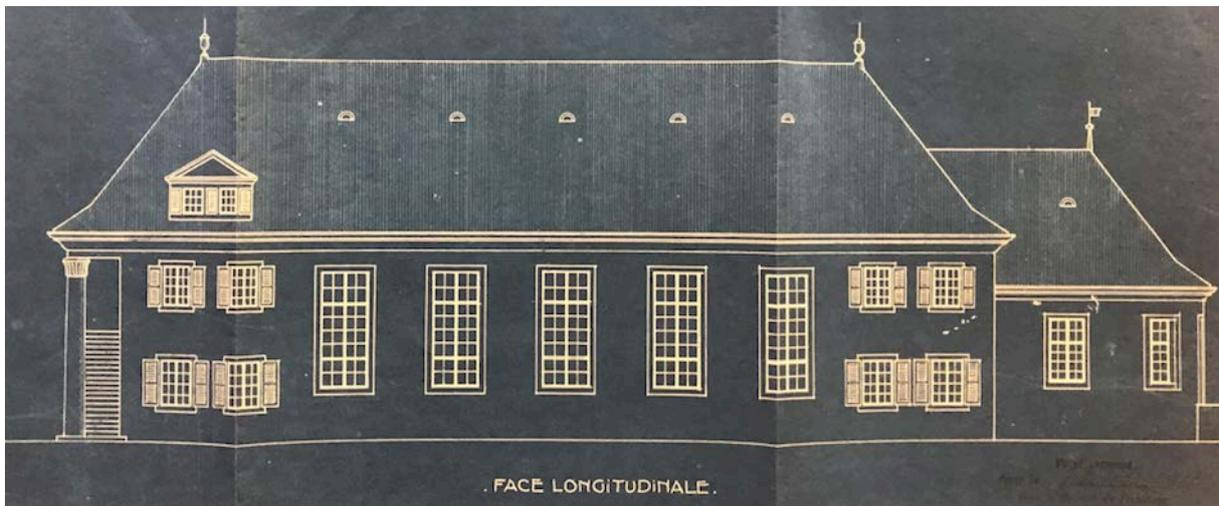
Les façades Nord et Sud étaient à l'origine identiques. Leur volume principal est symétrique avec cinq travées centrales de grandes fenêtres de 5 x 2 m, flanquées de deux petites travées avec des fenêtres sur deux niveaux. À l'Ouest au-dessus des petites fenêtres, une lucarne sur la toiture fait écho à la lucarne de la façade principale. À l'Est, un chevet en demi-cercle prolonge le corps principal. Son mur courbe s'élève sur 4m de hauteur et sa toiture en zinc un peu moins de 4m de hauteur.
